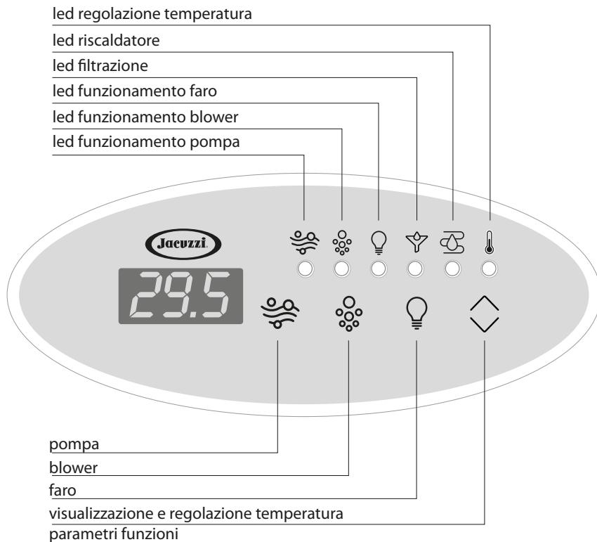
elettrico tubolare. Si raccomanda di non impostare temperature di riscaldamento dell'acqua eccessive, al limite dei 40 °C (la temperatura consigliata è di 35-36 °C).
