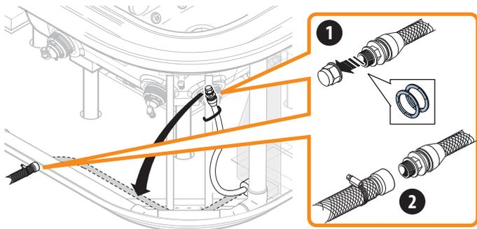
► Den Anschluss des Magnetventils an das Wassernetz vornehmen.
