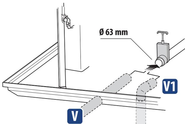
**Nota per il collegamento dello scarico delle vasche di compenso:** il tubo predisposto in fabbrica è dotato di un raccordo con guarnizioni al quale è possibile collegare il sistema di scarico dell'immobile; in alternativa, la vasca di compenso può essere direttamente collegata allo scarico (rimuovendo il tubo già predisposto) ed utilizzando quindi il raccordo in dotazione (o una valvola) per scaricare l'acqua quando necessario.
