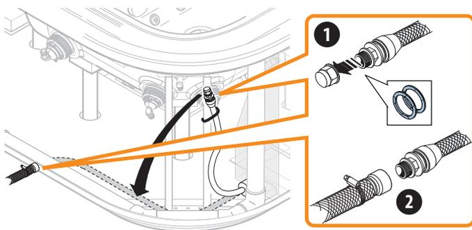
► Effectuer le raccordement de l'électrovanne au réseau hydrique.
